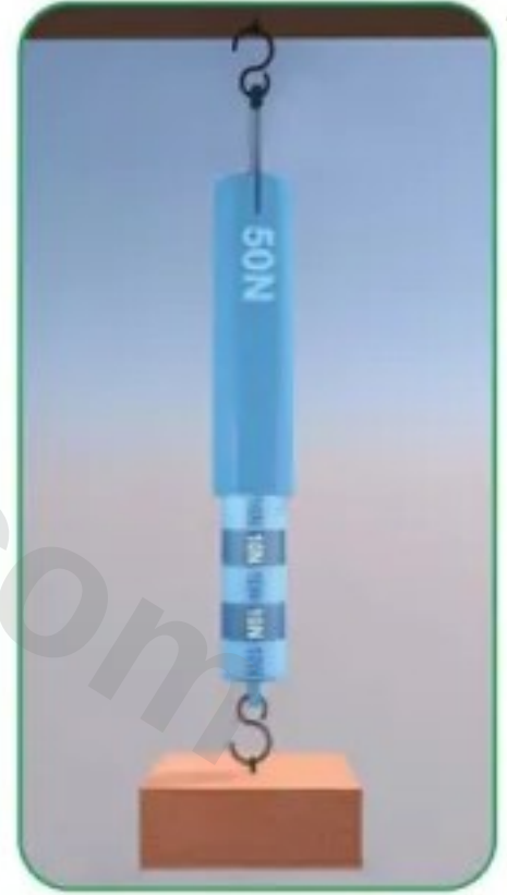
Görsel 2.1.8: Ölçebileceği kuvvet değeri ve bölme sayısı verilen dinamometre
